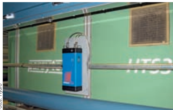
Abb. 3: Software-Plattform parsytec 5i mit berührungsfreier Längenerfassung ASCOSpeed
