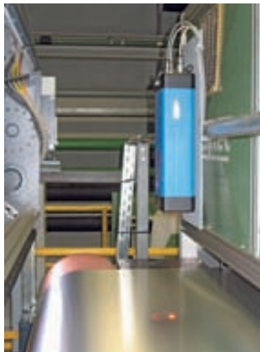
Abb. 4: ASCOSpeed misst die aktuelle Bandlänge berührungsfrei aus der Distanz
