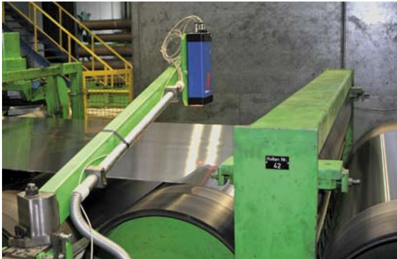
Abb. 3: Berührungslose Messung bietet Vorteile aufgrund der trägheitslosen und schlupffreien Messwerterfassung
