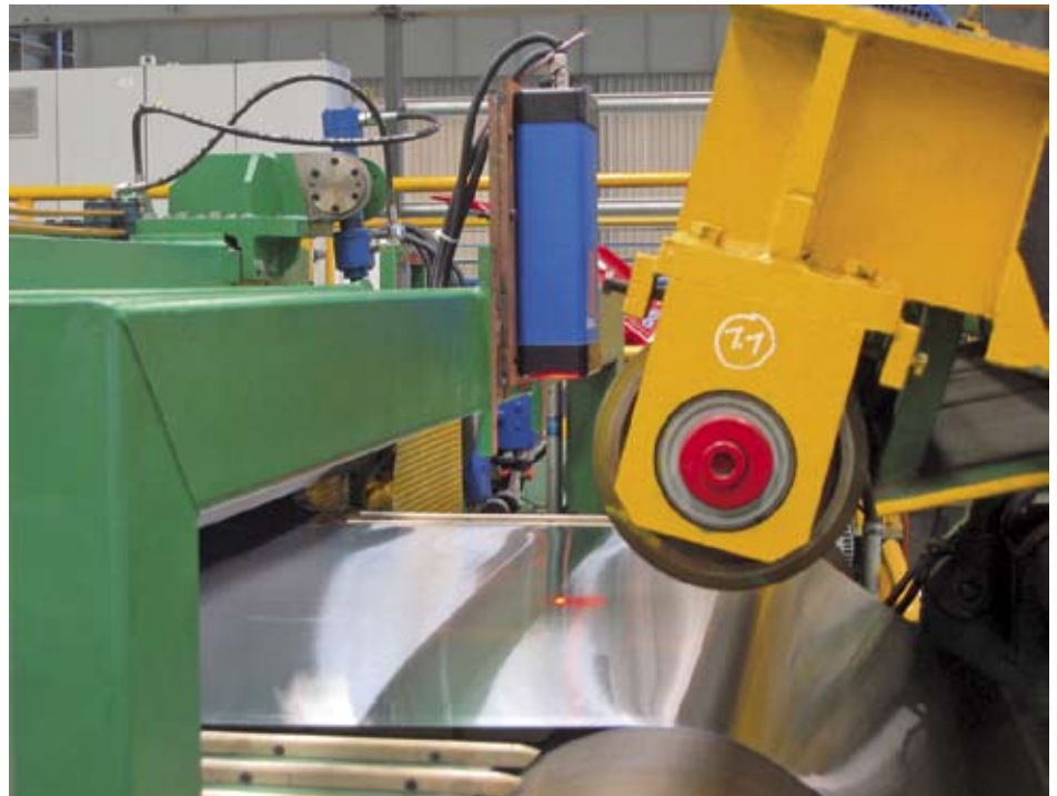
Abb. 7: ASCOSpeed-Installation an Hochgeschwindigkeitsbesäumschere Nanshan
