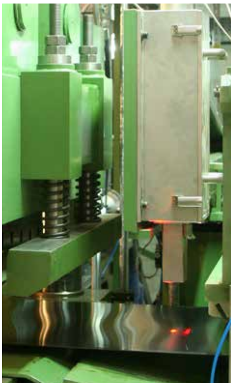
Bild 2: ASCOSpeed im Walzgerüst-Einlauf
