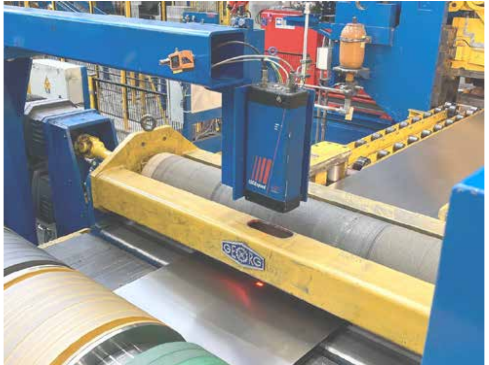
Bild 1: Geschwindigkeitsmessung an einer Spaltanlage
