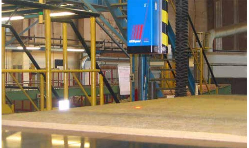
Bild 4 Geschwindigkeitsmessung von Platten © TB Sensor
