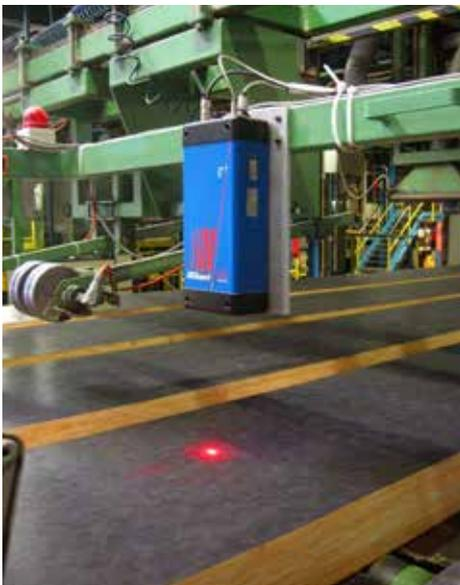
Bild 2 Längenmessung für den Zuschnitt © TB Sensor
