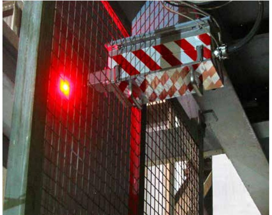
Bild 1 ASCOSpeed – Geschwindigkeitsmessung am Ausgang einer Kühlstrecke © TB Sensor
