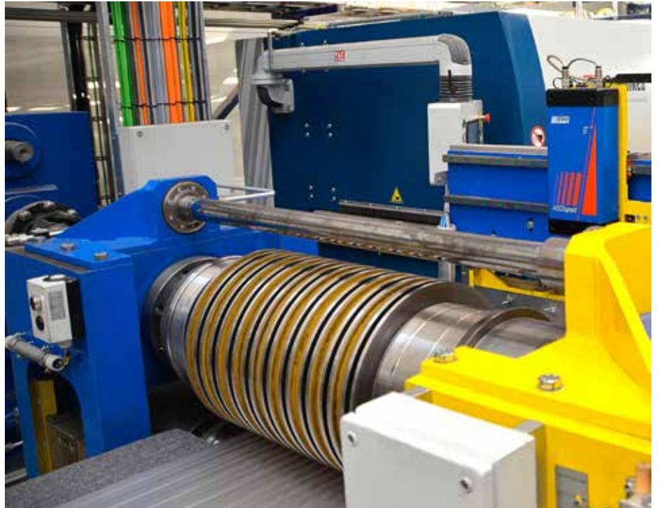
Bild 1: Geschwindigkeitsmessung mit ASCOSpeed an einer Spaltanlage alle Foto: NLT
