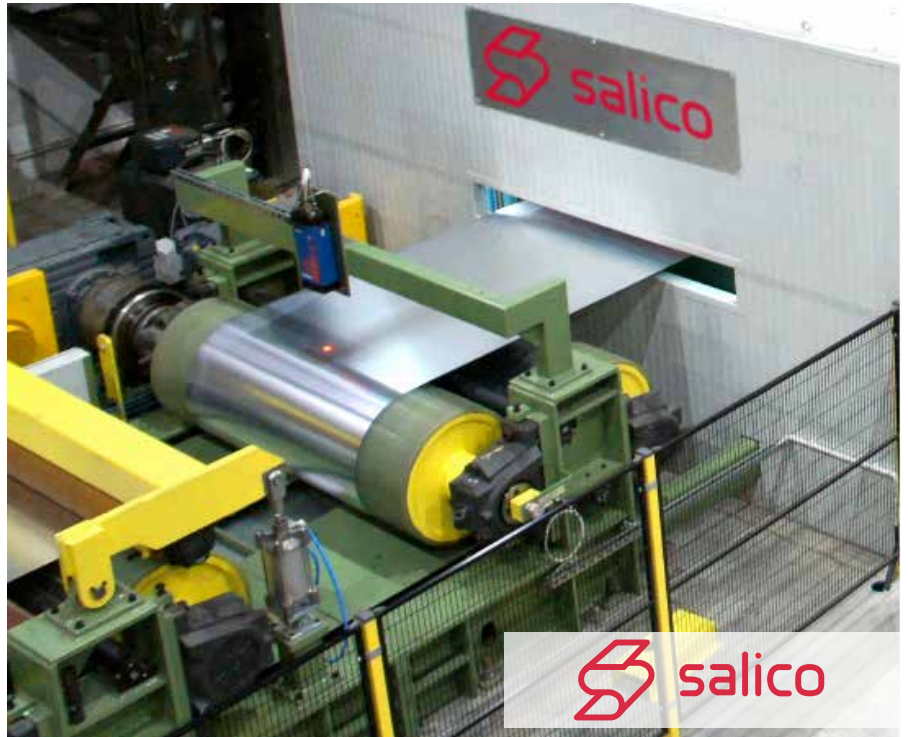
Bild 1: Geschwindigkeitsmessung am Einlauf einer Tension Leveling Line
